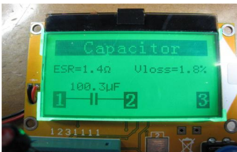
コンデンサーも取り外してアナライザーで測定するとESR値が1, 4Ωと良品の二倍の値
